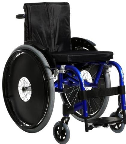
Dobrável em Duplo X; Protetor lateral de roupas tipo pára-lama, pedal tipo U com ajuste de altura e do ângulo de inclinação; Freios bilaterais ajustáveis; Rodas traseiras de 24”, pneus infláveis na cor cinza, aro propulsor em alumínio, cubos de alumínio montados com rolamentos blindados, eixo removível tipo quick release; Encosto com regulagem de tensão, almofada de alta densidade sobre o assento, Acabamento em pintura eletrostática; Peso - 14 kg, entre outros.
