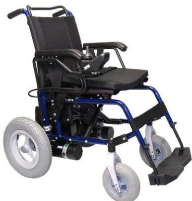
Estrutura de fechamento em X; kit Connect Microprocessado composto por drive e painel remoto, que pode ser instalado no lado direito ou esquerdo da cadeira; apoio de braço regulável nas alturas; motorização com dois motores elétricos de corrente contínua e ímã permanente de 200W cada; sistema de freio de estacionamento eletromagnético; capacidade de carga de até 130 kg; velocidade máxima de 7km/h
